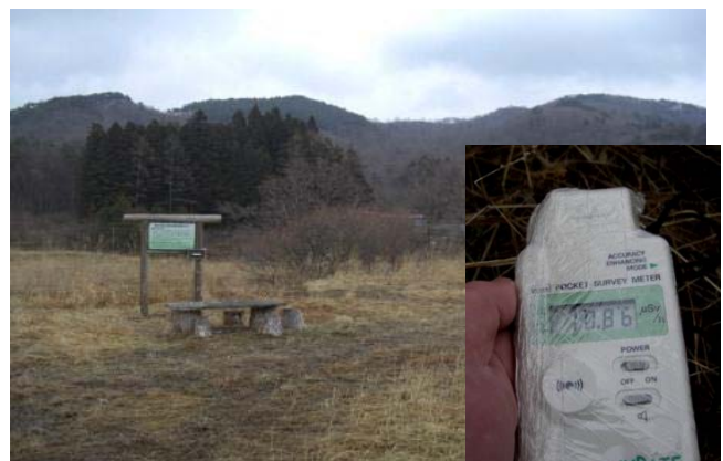
図5—浪江町水境で測定した場所とPDR-101の表示。 10.86\mu\text{Sv/h} を示している。
