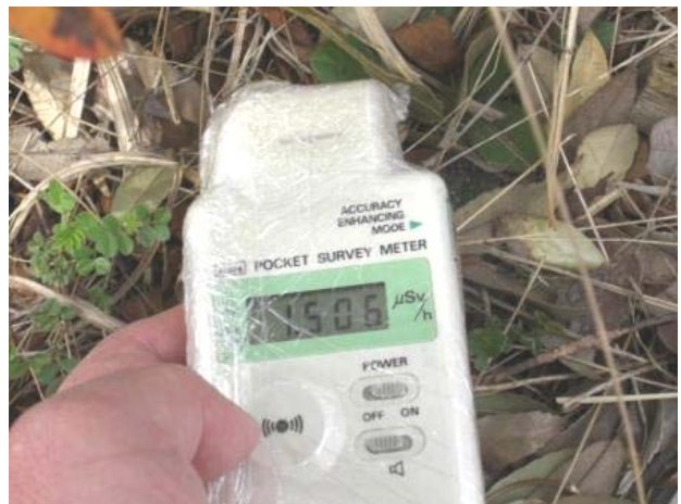
図3—檜葉町の検問所近くの山林での測定。 PDR-101は 1.506\mu\text{Sv/h} を示している
