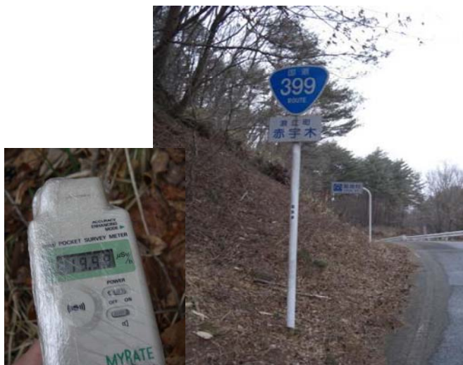
図6—浪江町赤字木手七郎で測定した場所とPDR-101の表示. 19.99\mu\text{Sv/h} で振り切れている
